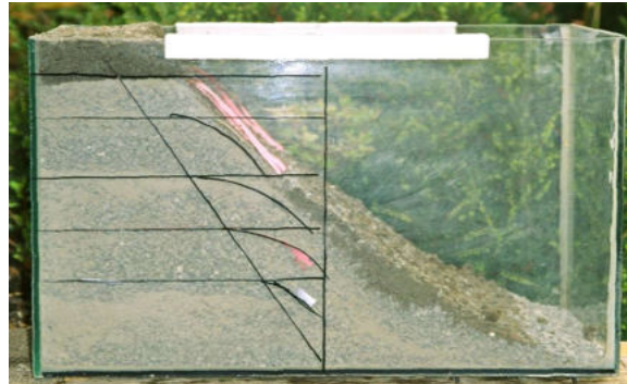
Abb. 30 zeigt nach dem Ziehen der eingestellten Glasscheibe die Lage des Basaltgruses und der Papierstreifen.
