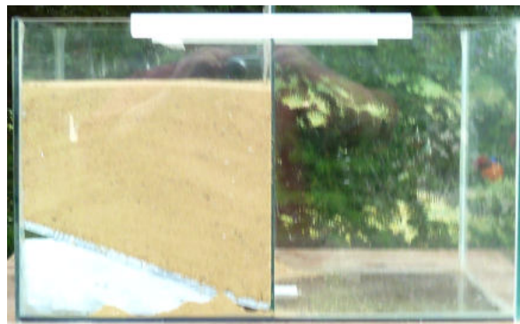
Abb. 96 zeigt den Glaskasten mit dem eingebauten Holzkeil, dessen Oberfläche einer Felsschicht entsprechen soll.
