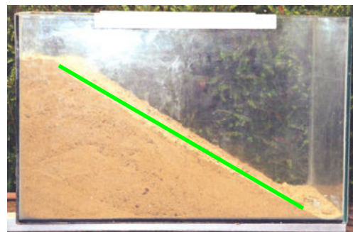
Abb. 74 zeigt die Scherebene (grün) und den Scherwinkel s des Sandes.
