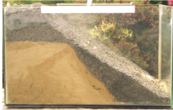
Abb. 32 zeigt nach dem Abgleiten der Füllstoffe die Neigungsebene des Sandes und die Scherebene des Gruses.
