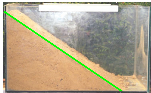
Abb. 80 zeigt die Scherebene nach dem Abgleiten des Sandes.
