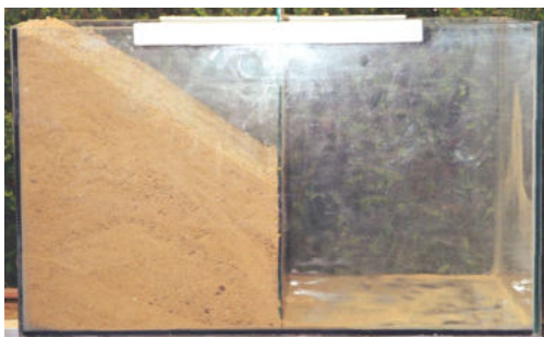
Abb. 79 zeigt den Sandkörper mit vollständig geneigter Oberfläche.
