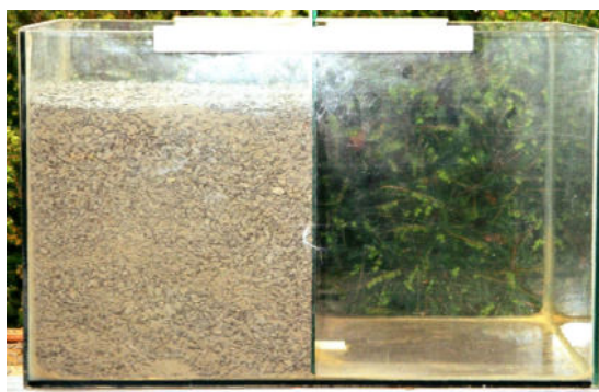
Abb. 42 zeigt den Glaskasten mit dem eingefüllten feuchten Basaltgrus.
