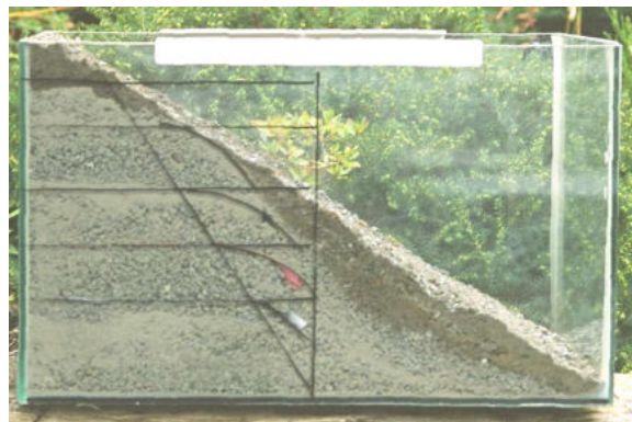
Abb. 31 zeigt die Lage des Basaltgruses nach dem Ziehen der Papierstreifen aus der 2. und 3. Schichtebene.
