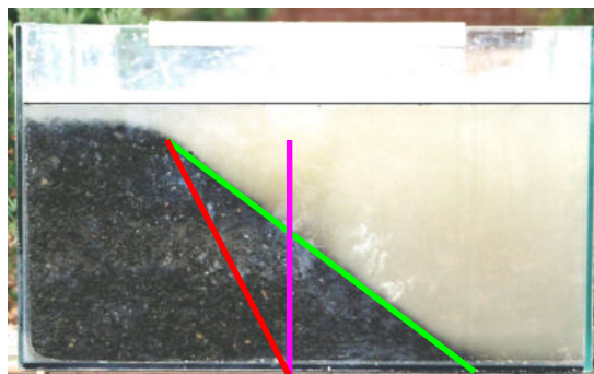
Abb. 48 zeigt die Scherebene des Basaltgruses unter Wasser.
