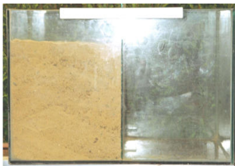
Abb. 73 zeigt den Sandeinbau mit horizontaler Oberfläche als Ausgangsbasis.
