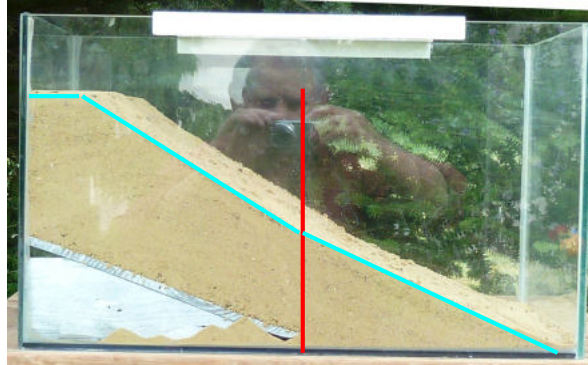
Abb. 97 zeigt nach dem Abgleiten des Gemisches einen Böschungsverlauf an zwei ungleichen Scherwinkeln.
