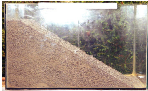
Abb. 43 zeigt die Lage der Scherebene des feuchten Basaltgruses.
