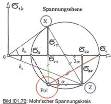
Bild I01.70: Mohr'scher Spannungskreis
