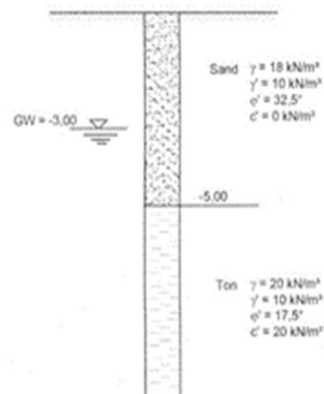
Bild L-4: Baugrundaufbau für alle Beispiele zum Erddruck
