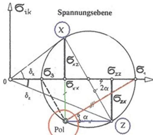
Bild I01.70: Mohr'scher Spannungskreis
