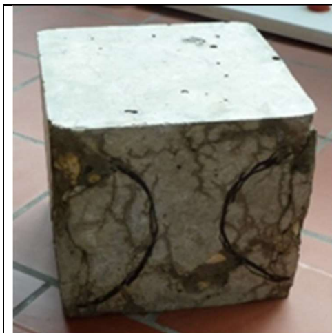
Abb. 28 zeigt, dass sich, wie bei den Kugeln im Behälter die größten horizontalen Kräfte bzw. Spannungen in halber Höhe des Betonwürfels eingestellt haben.
