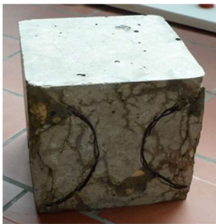
Abb. 38 zeigt die Bruchverläufe im Beton-Probewürfel.
