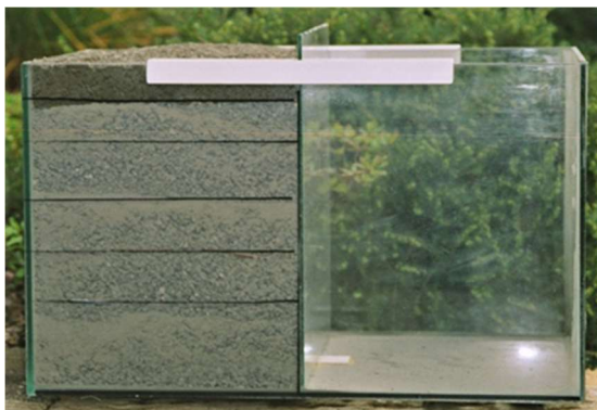
Abb. 28 zeigt den eingebauten Basaltgrus in die linke Kammer des Glasbehälters.
