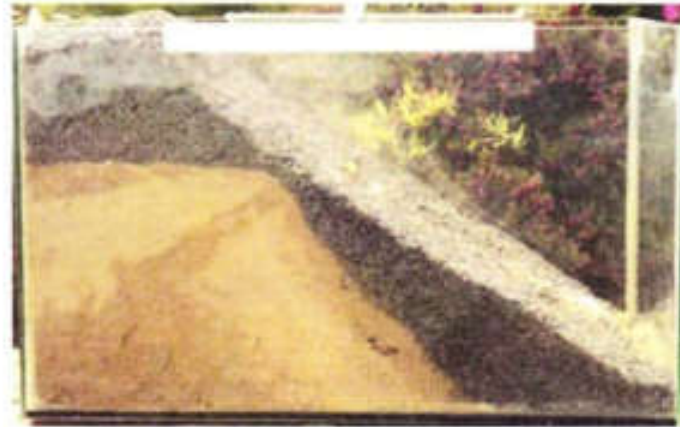
Abb. 15 zeigt nach dem Abgleiten der Füllstoffe die Lage der Neigungsebene des Sandes sowie die Lage der Scherebene des Gruses.
