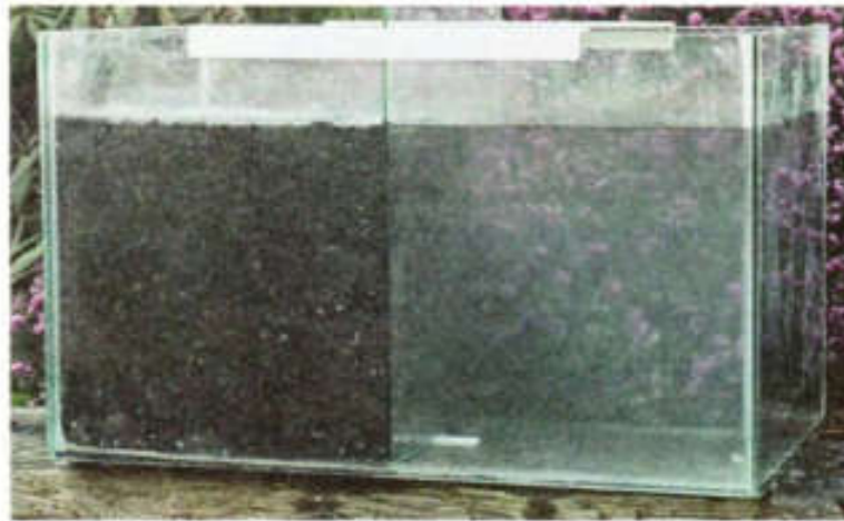
Abb. 69 zeigt die gleiche Füllhöhe h_b von Basaltgrus und Wasser vor dem Ziehen der Glasscheibe.
