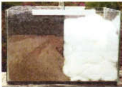
Abb. 148 zeigt die Füllung des Glaskastens mit den ungleichen Böden.
